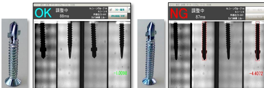
M4X35mm十字穴皿ねじ良品、先端角度不良品サンプルと検査画面
