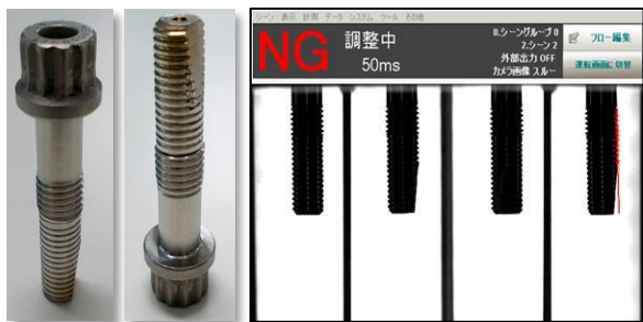
M8X35mmエンジンボルトねじ山つぶれ不良品サンプル
