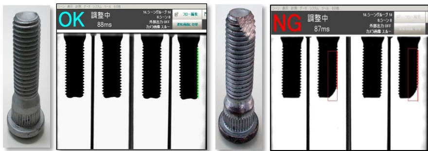
M14X40mmハブボルト良品、先端形状不良品サンプルと検査画面
