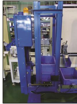
箱替え装置 ケースストッカー Yutaka's fully automatic case stocker
