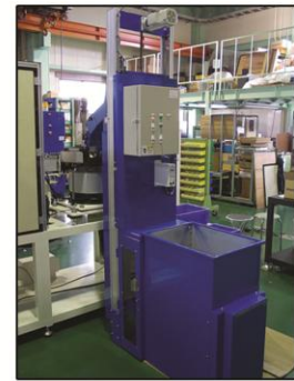
補助ホッパー Auxiliary Hopper
